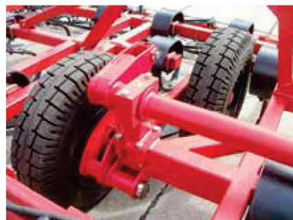
Механизм подката двух спаренных ходовых колес на центральной раме
